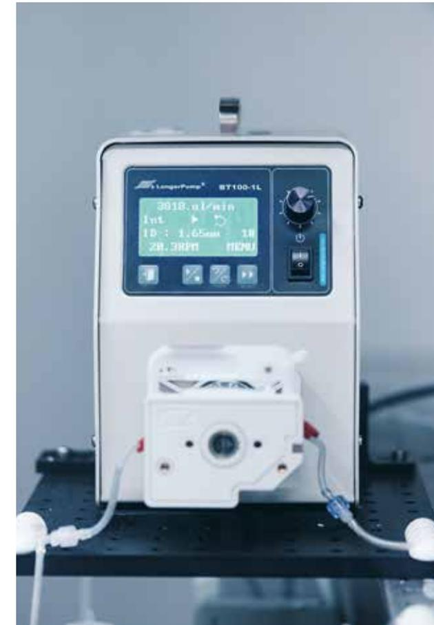
Die von einer Pumpe gesteuerte Durchflussmenge beträgt konstant 4 bis 5 Milliliter pro Minute.
